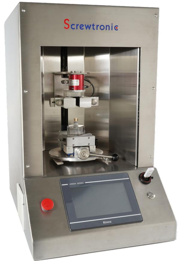
Elektrische Hochleistungs-Schraubstation, die speziell für kontrolliertes Festschrauben von Kunststoffverschlässen mit oder ohne Originalitätsring, für Zerstäuberpumpen, Dosierpumpen, Tropfenzähler usw. entwickelt wurde.
