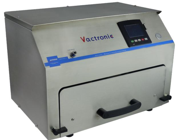
Es handelt sich um ein Leakprüfsystem mit Differenzdruckmessung unter einer Vakuumglocke um die Dichtigkeit verschloßener Pharmazeutischer Flaschen zu prüfen.
